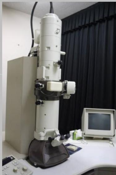
2. 超薄切された標本に電子ビームをあてて干渉像を拡大して観察できます。樹脂標本の超薄切装置は、光顕・電顕試料作成室にあります。
