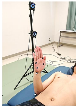
図2. 測定風景(左)と前腕回内・回外角度の解析方法(右)
