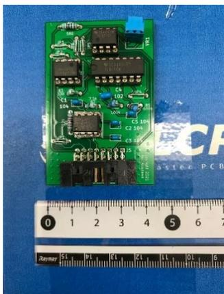
図1 マルチチャンネル表面筋電図用アンプ
